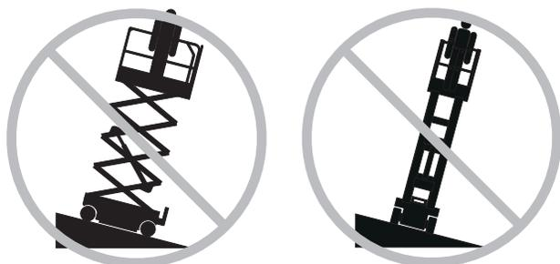
Não dependa do alarme de inclinação como um indicador de nível. O alarme de inclinação soa nos controles da plataforma e nos controles de solo quando a máquina está em um declive acentuado.
