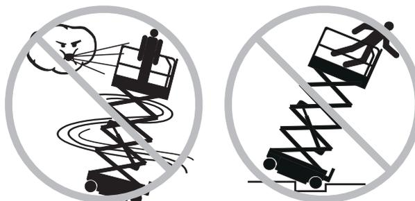
Dirija com extremo cuidado e em baixa velocidade com a máquina na posição retraída ao passar por terrenos irregulares, detritos, superfícies instáveis ou escorregadias e próximas a buracos e declives acentuados.
