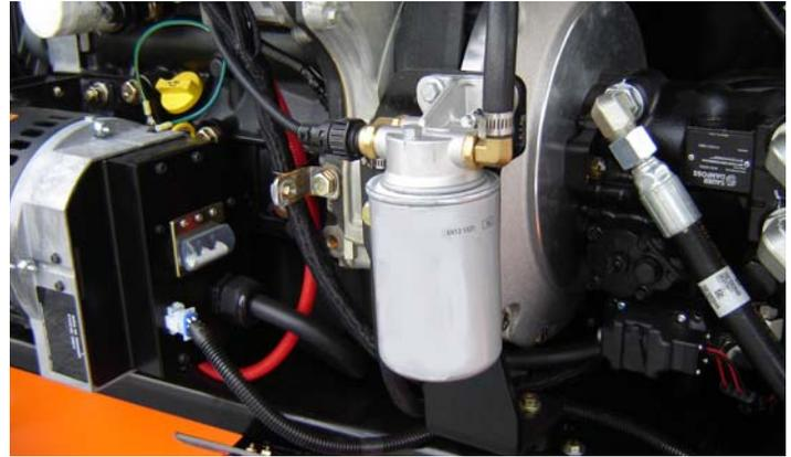
Ponto(s) de Lubrificação - Elemento Substituível
