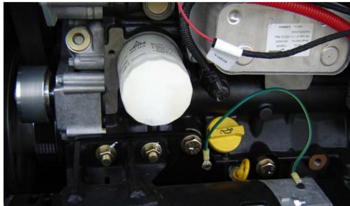
Pontos de Lubrificação — Tampa de Enchimento/Elemento Rosqueado
